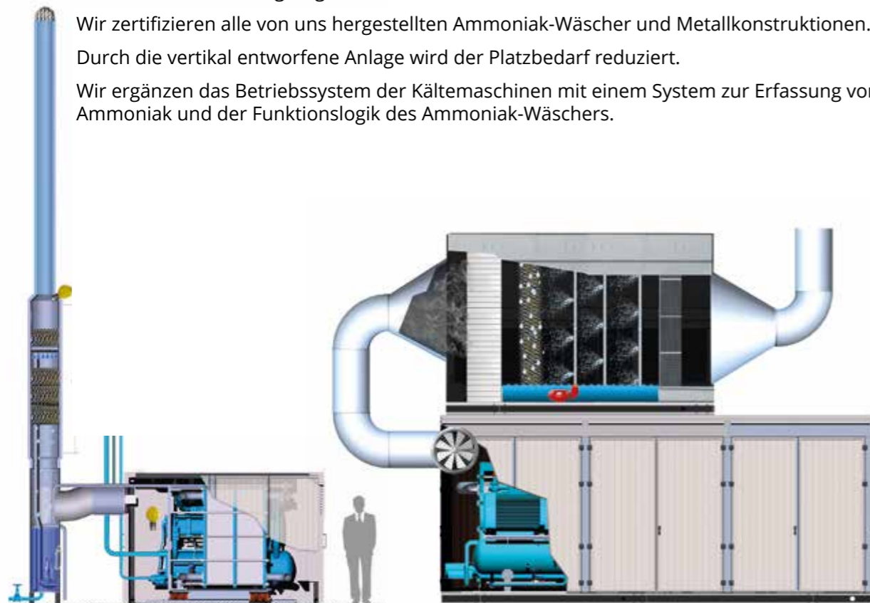
recumatik ® mit Innenkabine und vertikal montiertem Ammoniak-Wäscher
